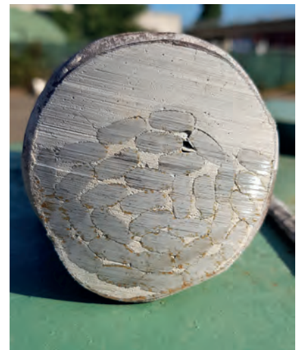
Spannstähle Typ SIGMA oval 40: Das sehr gut verfüllte Hüllrohr ist im Schnitt ebenso erkennbar, wie das Bündel der Spannstähle.
